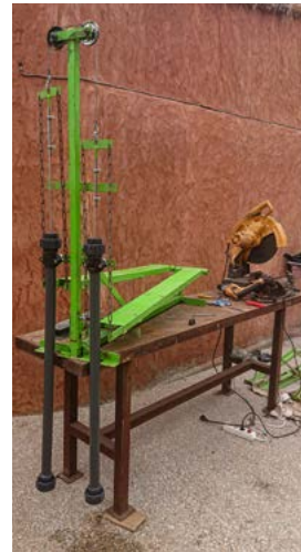
Umgebaute BASILEA Pumpe
